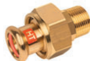
3-delige koppeling met vlakke dichting konische buitendraad x press
