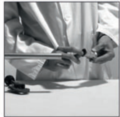
Fig. 19 Controle van de plaatsing van de o-ring
