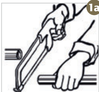
Fig. 9 Met behulp van een fijngetande ijzerzaag de buis loodrecht op de gewenste lengte snijden.
