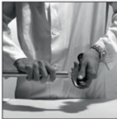
Fig. 18 Eventuele bramen verwijderen en buiseinde controleren op krassen, verontreinigingen of vervormingen.
