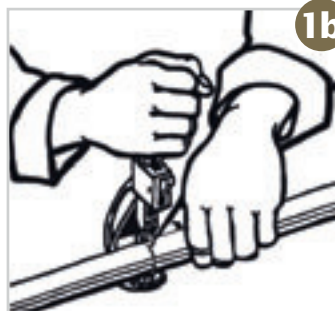
Fig. 10 Eventueel de buis met een cutter snijden.
