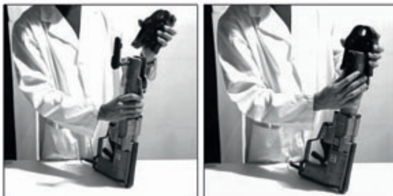
Fig. 22 - 23 In elkaar zetten van de bekken in de PRESS-tang
