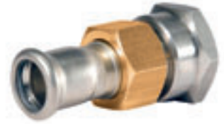
3-delige koppeling met vlakke dichting binnendraad x press
