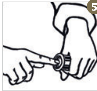
Fig. 14 Controleer de netheid van binnenzijde van de koppeling en corrigeer de zitting van de afsluitring; vergewis u van de afwezigheid van olie of vet.
