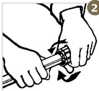
Fig. 11 Buis langs binnenzijde schoonmaken.
